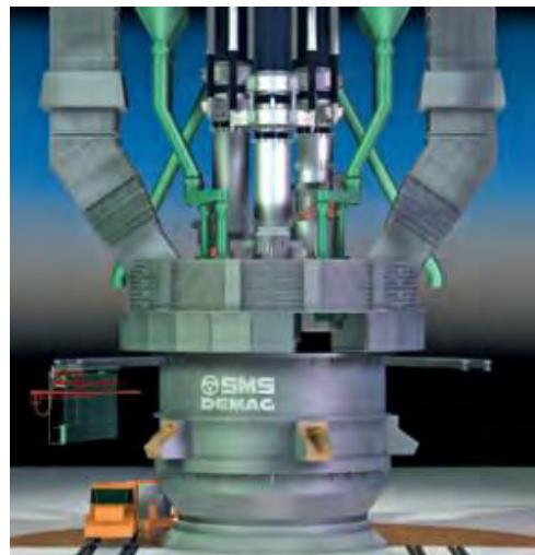
**Mynd 5:** Ljósbogaofn (Mynd SMS Siemag).
